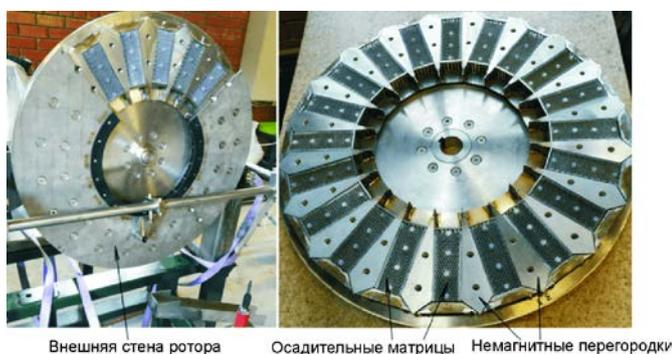
**Рис. 7.** Ротор сепаратора в процессе сборки
