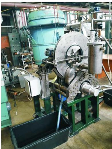
**Рис. 6.** Заключительный этап сборки сверхпроводникового магнитного сепаратора
