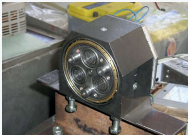
Рис. 4. Привод кресла инвалидной коляски-робота.
