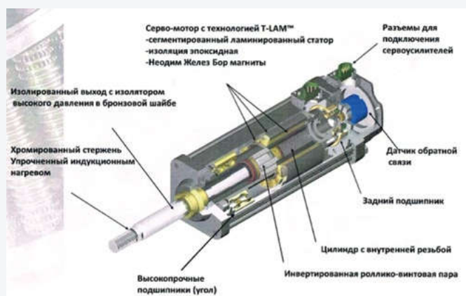
Рис. 3. Обращенная - инвертированная РВП в составе электроцилиндра фирмы Exlar
