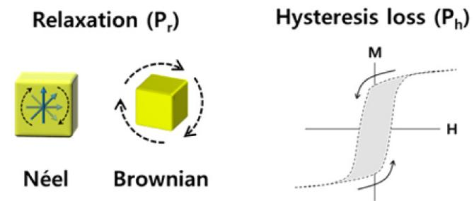
Рис. 5 Механизмы тепловых потерь при перемагничивании: неелевский, броуновский и потери на гистерезис.
