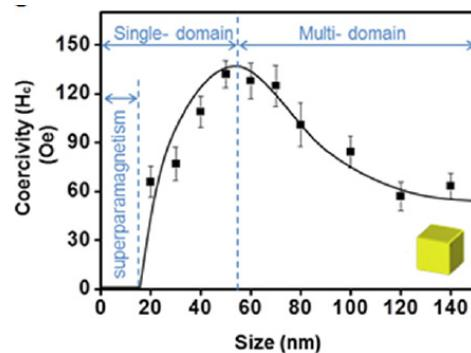
Рис. 3 Зависимость коэрцитивной силы от размера частицы: в суперпарамагнитном состоянии она равна нулю, а на границе монодоменного и многодоменного состояний достигает максимума.
