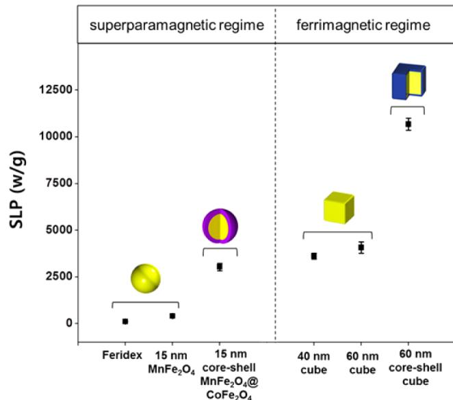
Рис. 6 Величины удельных потерь (Specific Loss Power, SLP) от размеров, форм и структуры наночастицы.
