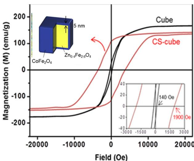
Рис. 4 Изменение формы петли гистерезиса и коэрцитивной силы при изменении структуры наночастицы на составную: с ядром и оболочкой (core-shell, CS).
