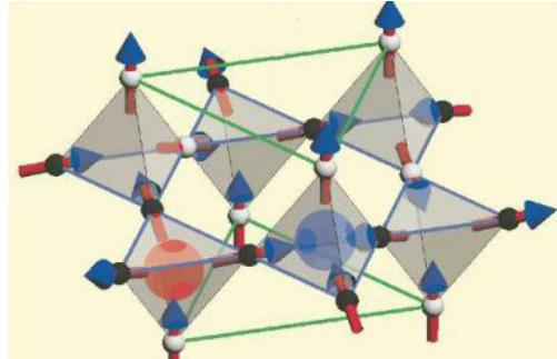
Рис.2 Образование пары монополей с противоположными магнитными зарядами. В левый нижний тетраэдр число «выходящих» спинов превышает число входящих, что приводит к появлению монополя (обозначен красным шаром). Аналогично в соседнем тетраэдре (центральный нижний тетраэдр) образуется монополь противоположного знака.
