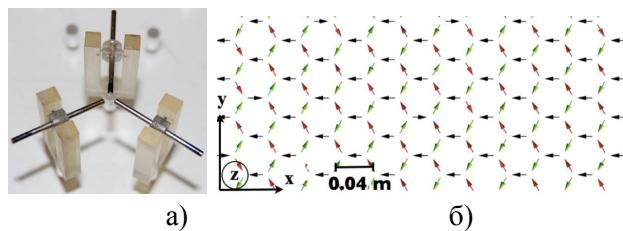
Рис.3 Демонстрационная модель фрустрированных состояний в магнетиках: в каждом узле решетки – вертушка с тремя магнитами [3].
