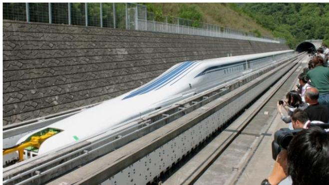
Поезда, использующие принцип магнитной левитации (Maglev) остаются наиболее перспективными из скоростных наземных видов транспорта, составляющих конкуренцию воздушному транспорту на средних расстояниях. В настоящее время рекордсменом является поезд, соединяющий Шанхай с его аэропортом: он может разгоняться до 430 км/ч (хотя в реальности эксплуатируется на скоростях 250 км/ч).
