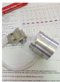
Микродвигатель синхронный для привода криогенной системы 25 Вт, 4000 об/мин
