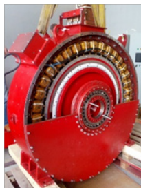
Тяговый мотор-генератор на постоянных магнитах 400 кВт, 130 об/мин
